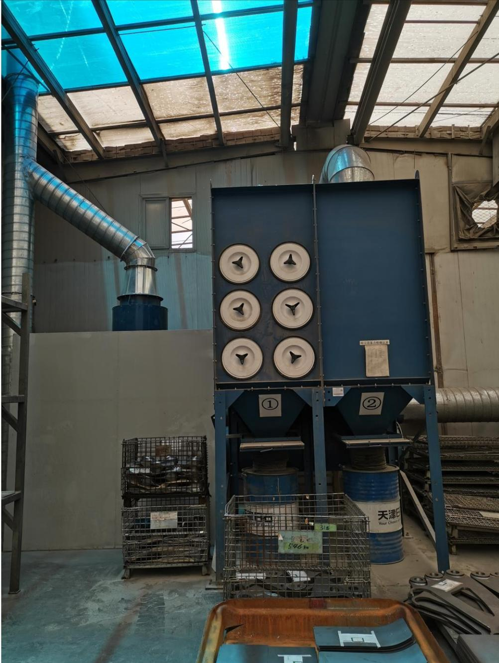
图 4-3 打磨工序除尘器
